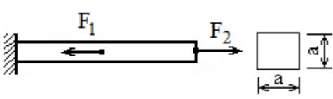
$F_1 = 10 \text{ кН}$ ,  $F_2 = 30 \text{ кН}$ ,  $\sigma_T = 300 \text{ МПа}$ ,  $n_t = 2,0$ . Из расчёта на прочность по допускаемым напряжениям определить размер поперечного сечения стержня
