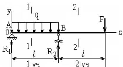
Для заданной балки построить эпюры поперечных сил  $Q$  и изгибающих моментов  $M$ .
