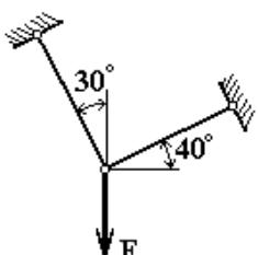
Из расчёта на прочность по допускаемым напряжениям определить требуемые площади поперечных сечений стержней.
