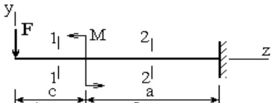
**Задача 3. Косой изгиб.** Задана балка, изготовленная из двух стальных швеллеров с расчётным сопротивлением материала  $R$ .
