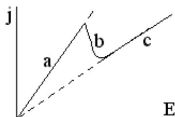
Приведена типовая зависимость плотности тока через полупроводник с многодолинной структурой зоны проводимости от напряженности поля.
