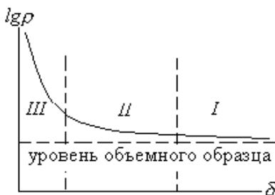
На графике представлена зависимость удельного сопротивления металлической пленки от ее толщины. На участке III ответственными механизмами за перенос зарядов являются: ...
