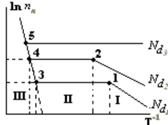
Приведены типовые температурные зависимости концентрации носителей заряда для полупроводника  $n$  – типа с различным уровнем легирования  $N_{d1}$ ,  $N_{d2}$ ,  $N_{d3}$ .
