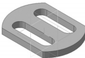
Рисунок 2.2. Элемент, образованный операцией выдавливания
