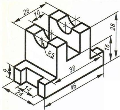
По двум видам построить 3-ю, и прямоугольную изометрию детали.
