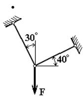
Из расчёта на прочность по допускаемым напряжениям определить требуемые площади поперечных сечений стержней.
