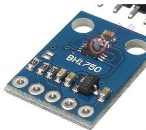
Рис. 2. Общий вид платы датчика освещенности.
