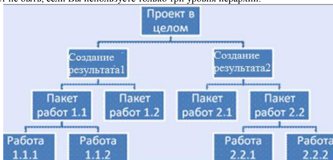
Рисунок 1 – Упрощённая иерархическая структура работ по проекту
