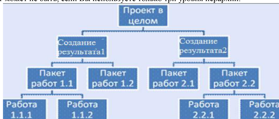
Рисунок 1 – Упрощённая иерархическая структура работ по проекту
